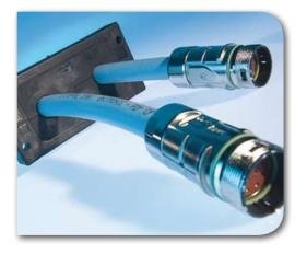
La placa pasacables tipo KDL/S es una placa pasacables especial que permite introducir diferentes cables de acuerdo con los deseos del cliente y cerrar aberturas. El manguito interior KDT/S puede ser diseñado de acuerdo con los deseos del cliente. Adecuados para recortes estándar para conectores de 16 polos, por ejemplo Harting, Wieland y Rittal
